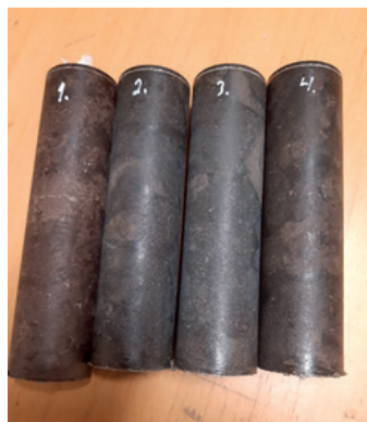
Kuva 23. Hankkeessa hankittu muotti sekä lieriöt ennen ja jälkeen puristustestin.
