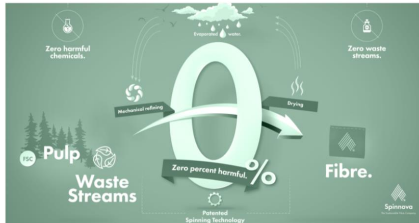
Kuva 18. Kuidun valmistuksen prosessikuvaus. https://spinnova.com/our-method/technology
